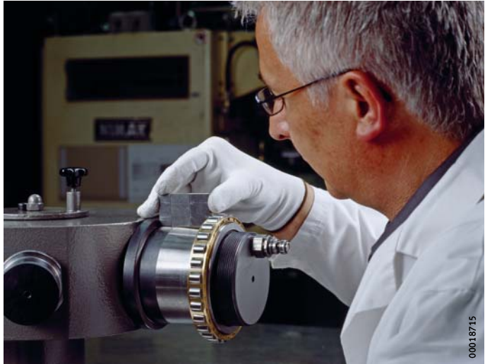
图 4 测量轴承内圈到轴肩的距离
