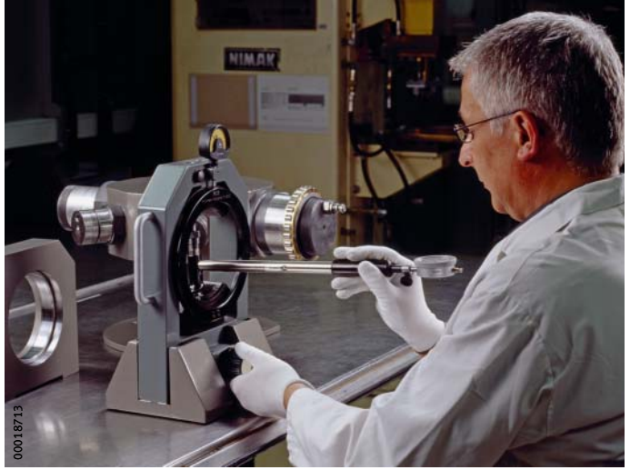
图 2 将测得的直径传递给包络圆测量仪
